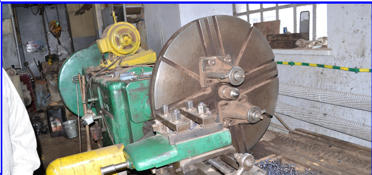
Wnętrze hali technicznej - tokarnia do przetwarzania wymiennych obręczy kół tramwajowych
